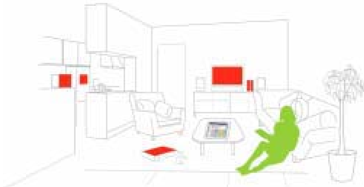
赤色はコントローラーとネットで接続された家電機器
